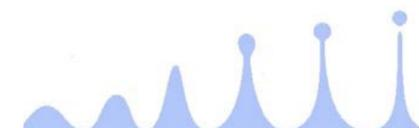
Эти механические колебания частотой до 3 МГц переносятся на пленку рассола. В жидкости возникают впадины и подъемы. На подъемах, начиная с определенной интенсивности колебаний, отделяются капли. Чем меньше капли, тем выше интенсивность колебаний.
